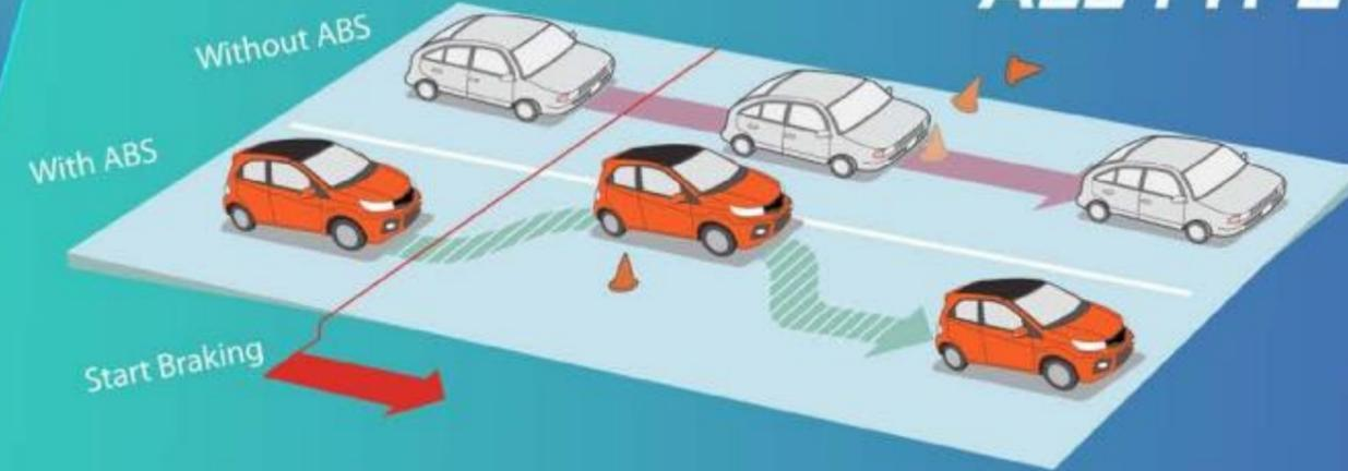
ABS (ANTI-LOCK BRAKING SYSTEM) MENCEGAH PENGUNCIAN RODA PADA SAAT PENEREMAN MENDAK. EBD (ELECTRONIC BRAKE-FORCE DISTRIBUTION) BERFUNGSI MENDISTRIBUSIKAN DAYA PENEREMAN SESUAI B
